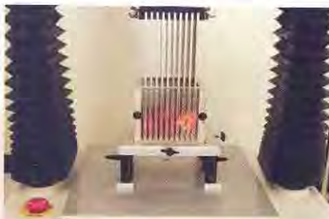
Figura 6.4 - Texturômetro Stable Microsystems TA-Hdi, com ensaios de Kramer Shear Cell, nas seguintes condições: célula de carga = 500 N, velocidade = 3,33 mm.s -1
