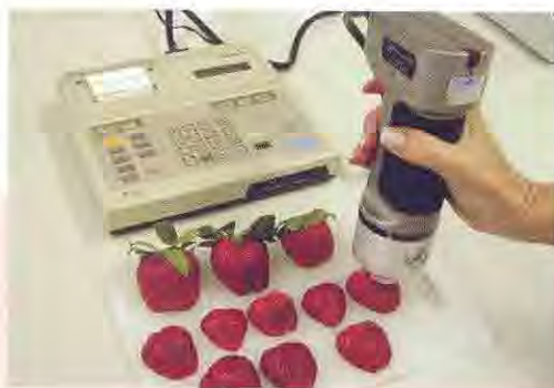
Figura 6.6 - Colorímetro de refletância Minolta Chroma Meter CR 200b, com os valores ( L^* a^* b^* ) convertidos em coloração H^* = \arctg a/b e saturação C^* = (a^{*2} + b^{*2})^{1/2}
