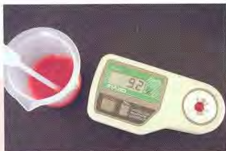
Figura 6.8 - O teor em sólidos solúveis (SS) é determinado pelo Refractómetro Digital PR-100 Atago
