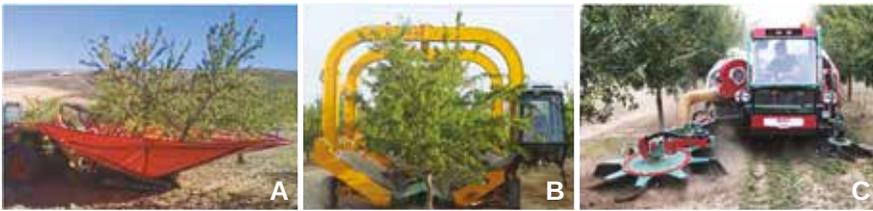
Figura 9 – Recolha de amêndoa através do vibrador de troncos com apara frutos (A). Vibrador de troncos ‘Tenías’ usado na colheita contínua da amêndoa (B). Equipamento para a recolha de amêndoa diretamente do chão (C) (Fotos B e C de VIMAR Equipos)
