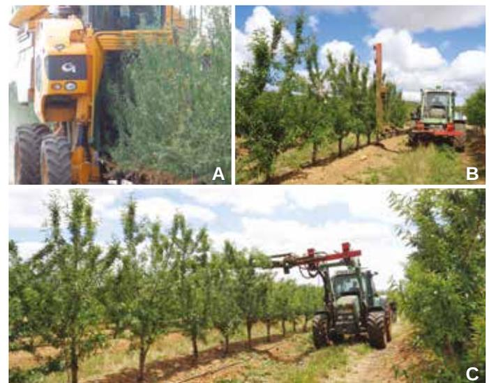
Figura 7 – Vibrador de copa (‘Máquina cavalgante’) usado na colheita (A) e poda mecânica em verde do amendoal em sistema superintensivo (B e C)
