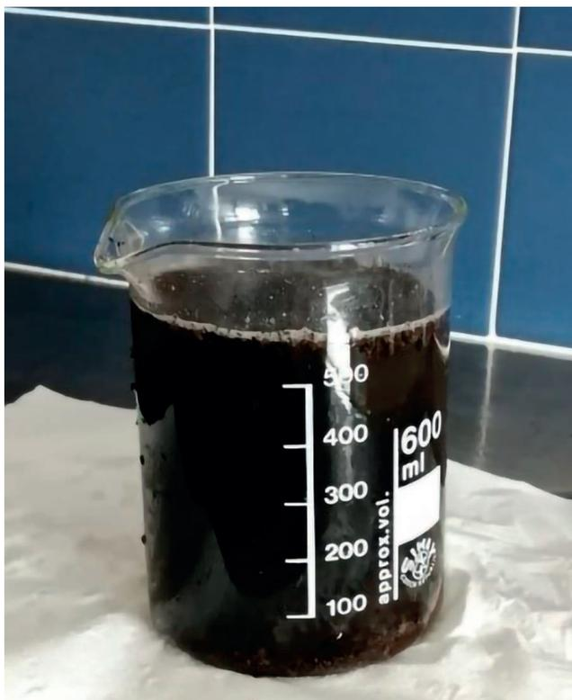
**Figura 1** – Produto obtido após digestão anaeróbia de chorume de suíno.
