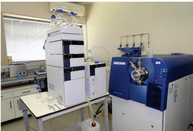
**Figura 5** – Sistema de Cromatografia Líquida acoplado a sistema de Espectrometria de Massa com detetor Tempo de Voo (UHPLC – ToF-MS/MS).
