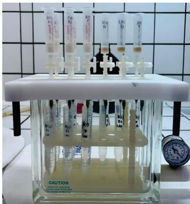
**Figura 4** – Representação do procedimento de extração em fase sólida (colunas de extração e sistema de vácuo).
