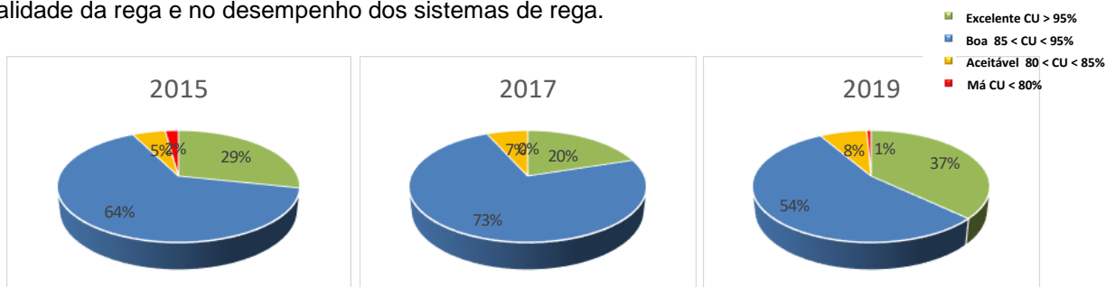
Figura 2.15 – Coeficiente de Uniformidade em sistemas de rega localizado
