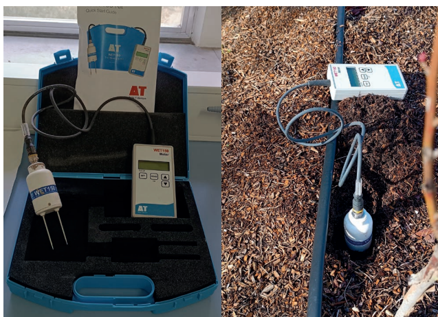
Figura 2 – Aspectos do sensor do solo Delta-T ® WET 150, Soil Moisture KIT.
