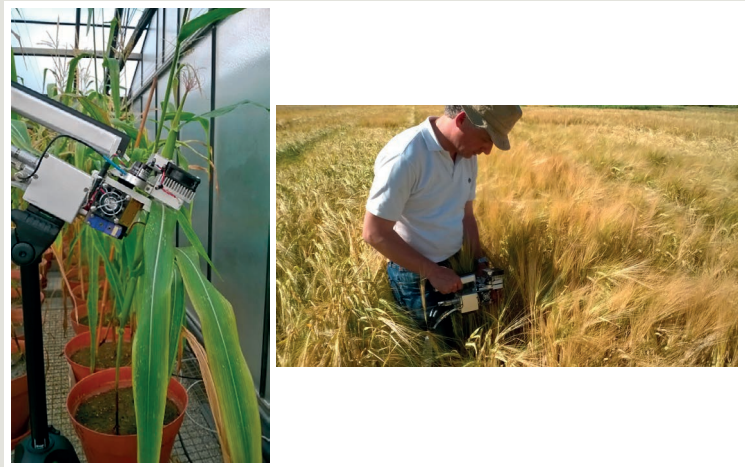
Figura 4 – Utilização de um IRGA para determinação de trocas gasosas em folhas de milho e trigo sujeitas a diferentes regimes hídricos
