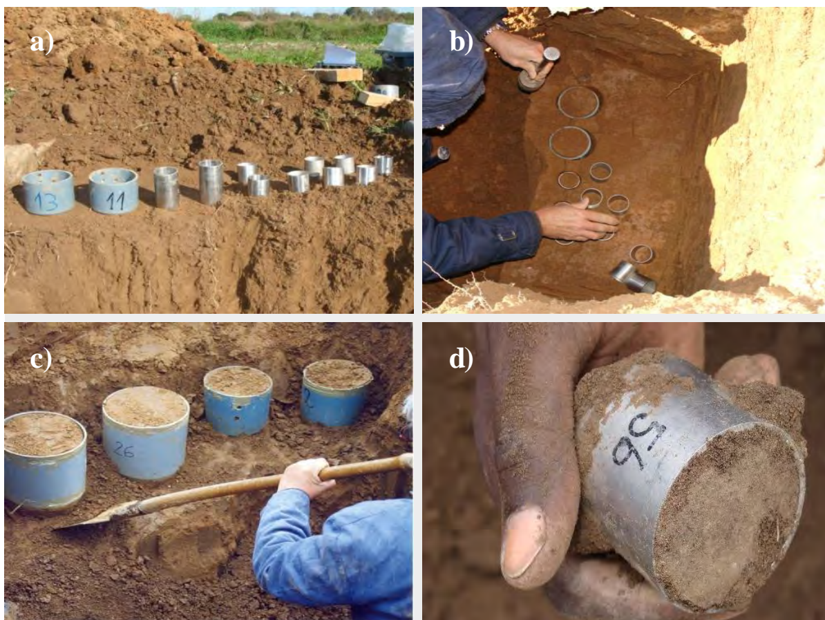
Fig. 5. Colheita de amostras não perturbadas. Os cilindros metálicos ou de pvc são enterrados lentamente de modo a perturbar o mínimo possível a estrutura do solo. No caso dos cilindros maiores, é, geralmente necessário retirar o solo envolvente para que seja possível enterrar o cilindro com a menor compactação. (a) Exemplo de cilindros usados na colheita de amostras não perturbadas; (b) cilindros enterrados num horizonte/camada de solo; (c) processo de colheita das amostras de maior dimensão; e (d) amostra não perturbada.
