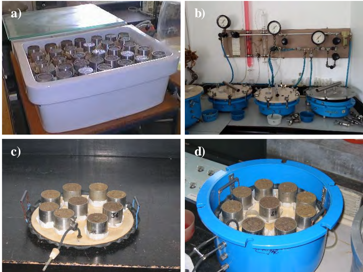
Fig. 6. Métodos laboratoriais usados na determinação dos teores de água correspondentes à capacidade de campo e ao coeficiente de emurchecimento permanente. (a) caixas de areia com amostras de solo não perturbadas; (b) painéis de pressão; (c) amostras de solo não perturbadas sobre a placa de cerâmica usada para extrair a água das painéis de pressão; (d) e amostras de solo não perturbadas sobre a placa de cerâmica dentro de uma painél de pressão.
