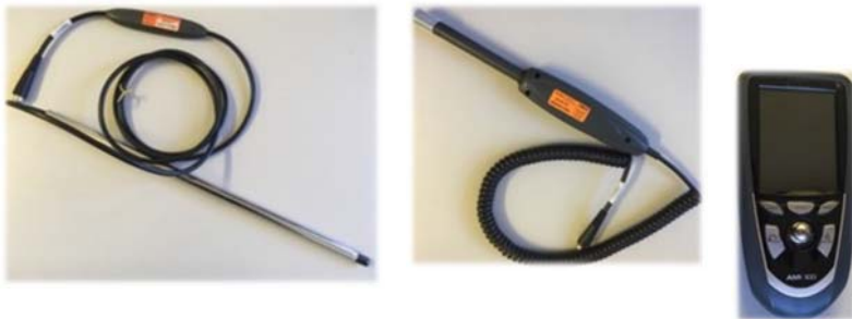
Figura 3.2: Anemómetro de fio quente e sensor de temperatura e humidade
