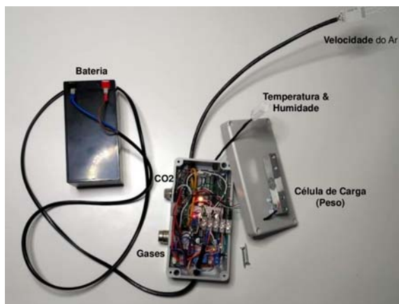
Figura 5.14: Sistema de monitorização
