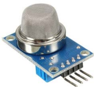
Figura 5.9: Sensor de gases MQ-135 (NH 3 , NO x , álcool, benzeno, fumo, CO 2 )
