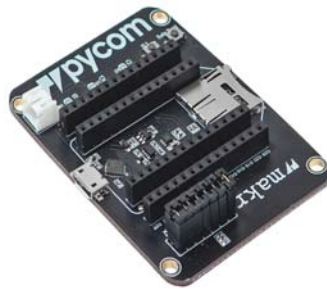
Figura 5.3: Placa de expansão Expansion Board 3.0 da Pycom (Fonte: https://pycom.io/ )
