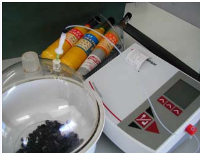
Figura 6 - Aspecto da medição de gases para determinação taxa respiratória e representação gráfica da taxa respiratória de quatro cvs de mirtilo [18] .
