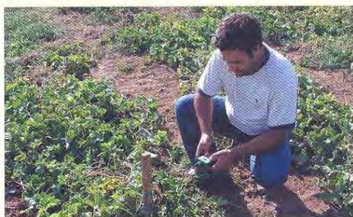
Figura 2.6 Avaliação da humidade do solo com um sensor do tipo Watermark (Herdade da Comenda, Caia, 2002)
