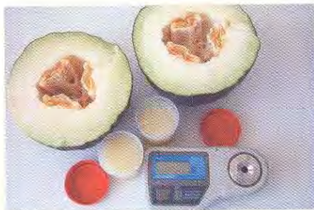
Figura 4.1 Determinação do conteúdo de sólidos solúveis totais com o refractómetro Digital Atago PR32 (Universidade de Évora, 2003)
