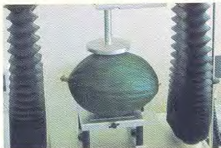
Figura 4.2 Avaliação da firmeza do fruto com o texturómetro TA-HDI-Texture Analyser da Stable Micro Systems (Universidade de Évora, 2003)
