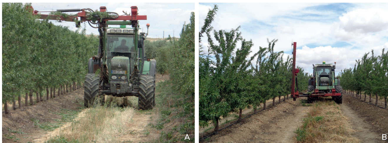
Figura 4 – Máquina de podar de discos montada no carregador frontal do trator usada na poda em verde dos topos (A) e das faces laterais (B) da sebe.
