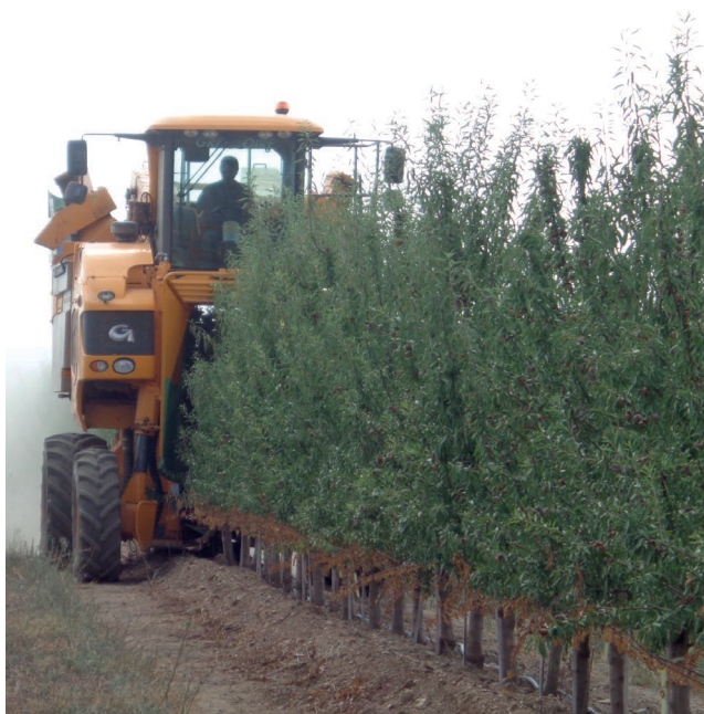
Figura 3 – Vibrador de copa (‘máquina cavalgante’) usado na colheita do amendoal superintensivo.
