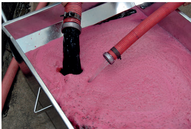
Figura 2 – Produção de vinho licoroso: neste tipo de vinificação, a operação crucial, designada aguardentação, consiste na adição de álcool de origem vitícola ao mosto parcialmente fermentado, por forma a “abafar” a transformação bioquímica em curso por morte das leveduras, devido ao excesso de álcool.
