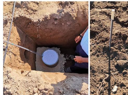
Figura 2. Imantação de lisímetros, com 2m de profundidade, para controlo da lixiviação de nitratos, e imagem do perfil do solo, evidenciando a compactação do mesmo
