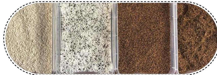
Figura 5 – Matérias-primas alternativas. Da esquerda para a direita apresenta-se perlite, granulado de esferovite, granulado de cortiça ADT e falca. (Fotos: ISA).
