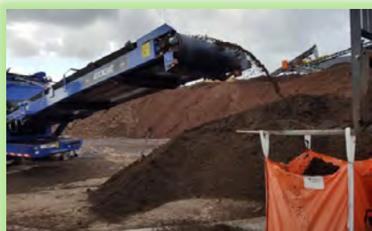
Crivagem no fim da compostagem, para obter uma granulometria 0-20 mm
