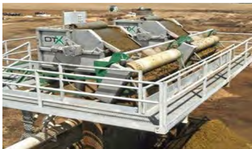
Figura 28. Separador de prensas de rolos combinado com separador de tela rotativa
