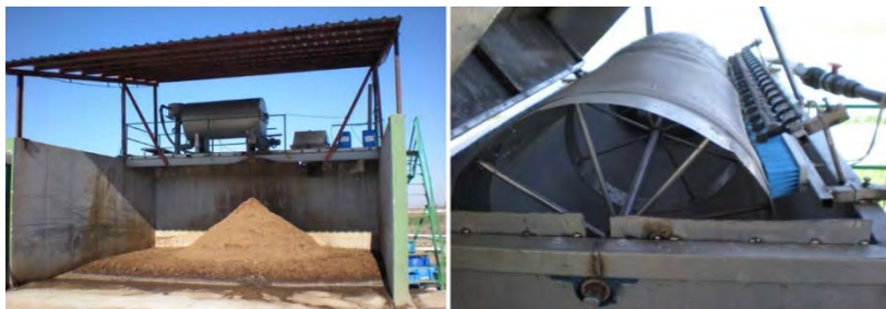
Figura 25. Separador de tela rotativa (Adaptado de Bernal et al., 2015)
