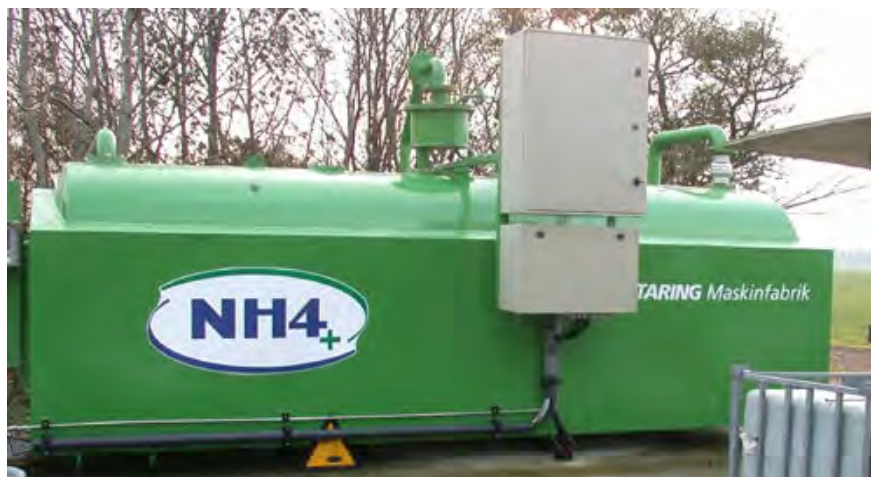
Figura 44. Unidade de controlo da adição de ácido sulfúrico e monitorização de pH de chorume na fase de armazenamento exterior ou interior de instalações pecuárias
