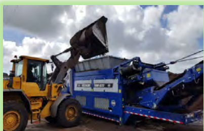
Crivagem no fim da compostagem, para obter uma granulometria 0-20 mm
