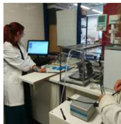
Figura 13 Extração e captura das substâncias voláteis emitidas pelos adultos de L. occidentalis , e exemplo dos equipamentos utilizados para caracterização e determinação da actividade biológica das substâncias voláteis (© Eduardo Mateus @Resolution Lab)
