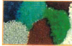
Figura 6b - Aspecto de granulados obtidos por reciclagem de diversos tipos de plástico.
