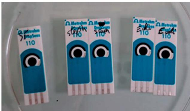
**Figura 3** – Biossensores eletroquímicos utilizados para detetar bactérias Gram-positivas (*Staphylococcus aureus* e *Bacillus cereus* foram testados como organismo-tipo).
