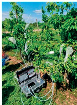
**Figura 6** – Protótipo do Projeto PurPest a ser testado no campo para recolha de compostos orgânicos voláteis para deteção de pragas (<https://www.purpest.eu>).
