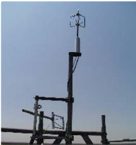
Figura 2 - Anemómetro sónico e higrómetro Krypton
