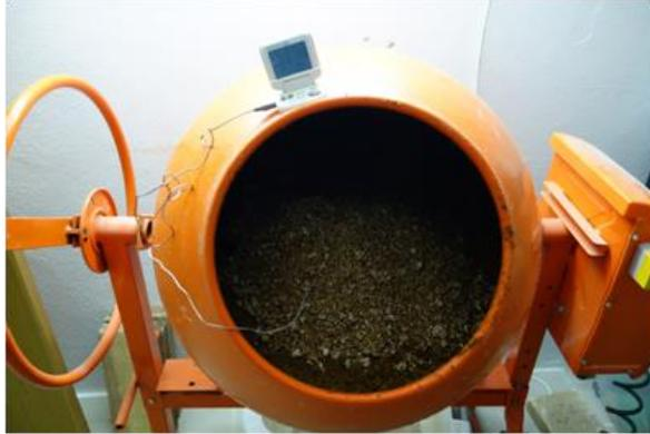
**Figura 12** - Misturadora (betoneira adaptada) para preparar substrato
