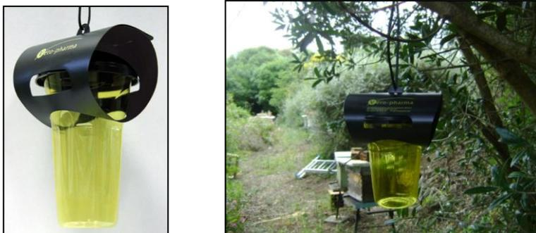
Fig. 5 – Armadilha entomológica comercial tipo Véto-Pharm e instalação perto do apiário a 1,5m de altura em relação ao solo.
