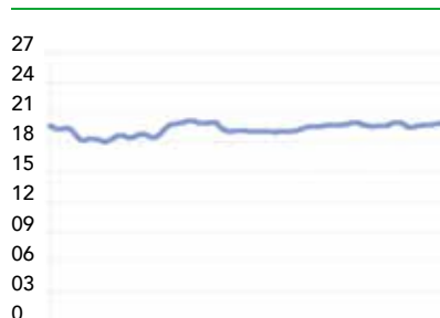
Figura 26. Representação gráfica da monitorização remota e em tempo real da temperatura (C°), humidade (%) e concentração de CO 2 (ppm) através de sondas instaladas nas barricas de armazenamento de milho colocadas na Agromais.
