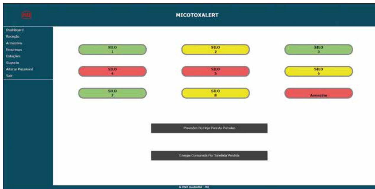
Figura 31. Sistemas de alertas gerados na plataforma "MICOTOX ALERT" através da recolha remota dos dados emitidos pelos sensores colocados durante o armazenamento do milho.
