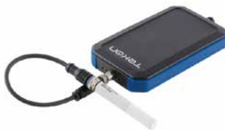
Figura 25. Sondas (TEKON's DUOS hygrotemp e CO 2 ) utilizadas para monitorização do CO 2 no milho armazenado em barricas na Agromais.
