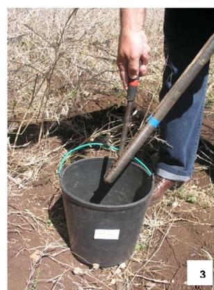
Fig. 1 - Enterramento da sonda no solo à profundidade adequada à cultura a instalar
