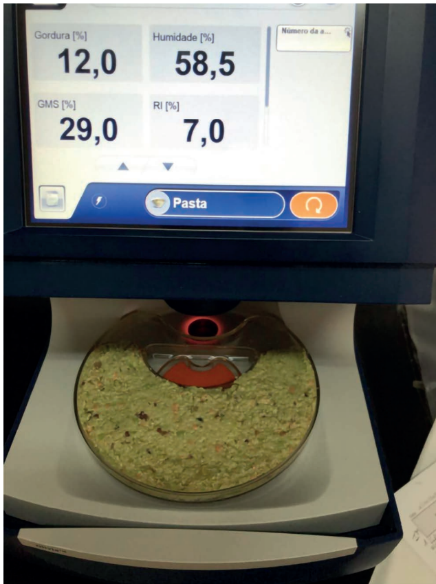
Figura 3 – Determinação do teor de gordura na pasta de azeitona com leitura por NIRS.
