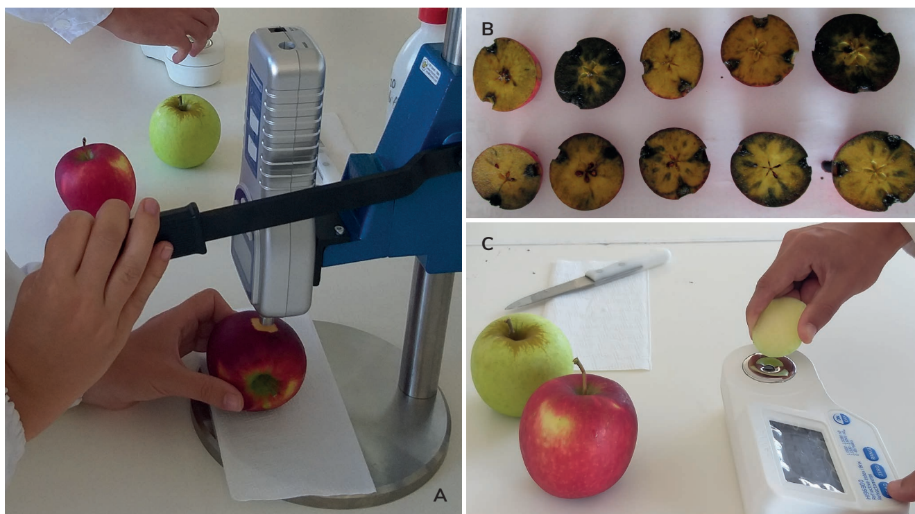
Figura 1 – Métodos convencionais para determinação de parâmetros de qualidade em frutos: firmeza (A), índice de regressão do amido (B) e teor de sólidos solúveis totais (C).
