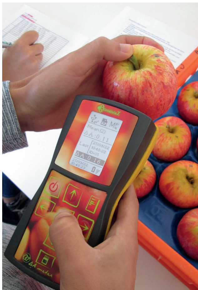
Figura 2 – DA-Meter®, equipamento portátil que permite uma avaliação rápida e não destrutiva do estado de maturação dos frutos.
