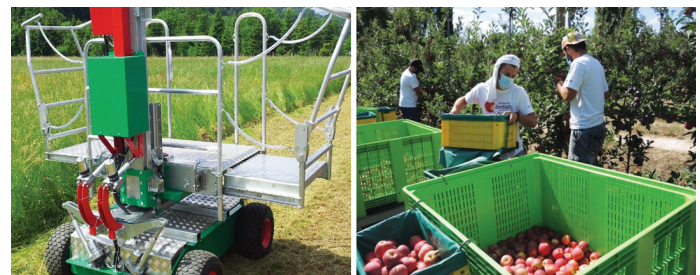
Figura 16 – Equipamento elétrico para auxílio na colheita e redução da pegada de carbono (esq.) e colheita otimizada com atrelados para redução de distâncias de transporte dos frutos, número de impactos e triagem qualitativa (dir.)
