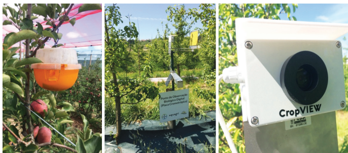
Figura 13 – Armadilha para controlo e captura em massa da mosca do mediterrâneo (esq.), placa cromotrópica digital (centro) e armadilha inteligente para monitorização do bichado (dir.)
