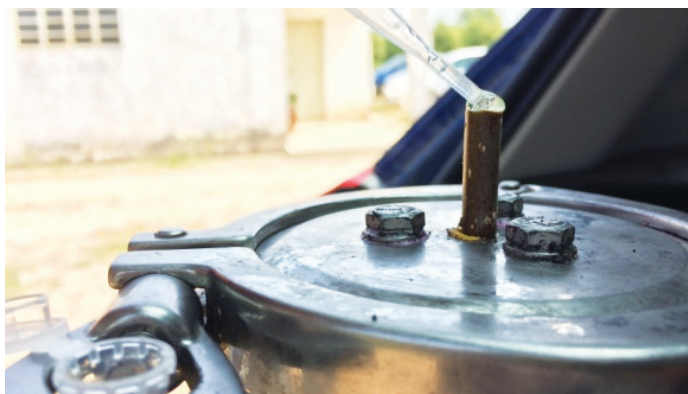
Figura 10 – Extração de seiva no campo para diagnóstico rápido do estado nutricional das plantas
